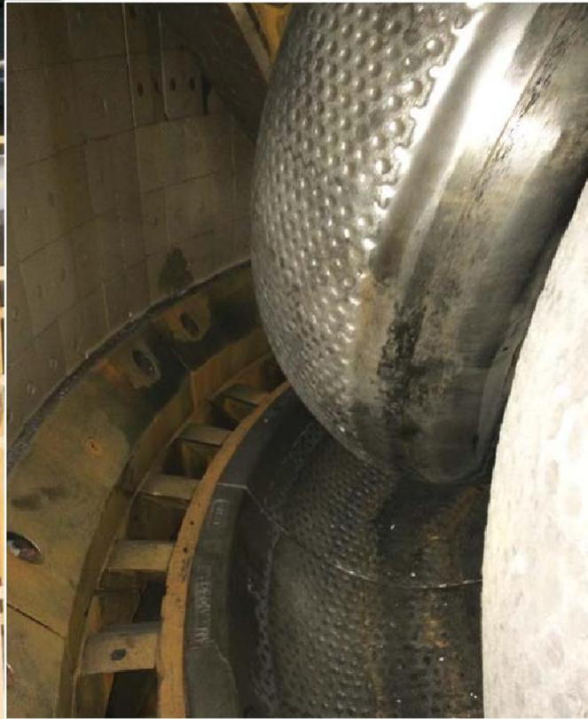
*La tecnología de materiales Xwin de Magotteaux combina la extrema dureza de la cerámica con las propiedades mecánicas del metal de alto cromo para una máxima resistencia al desgaste y vida útil.*
