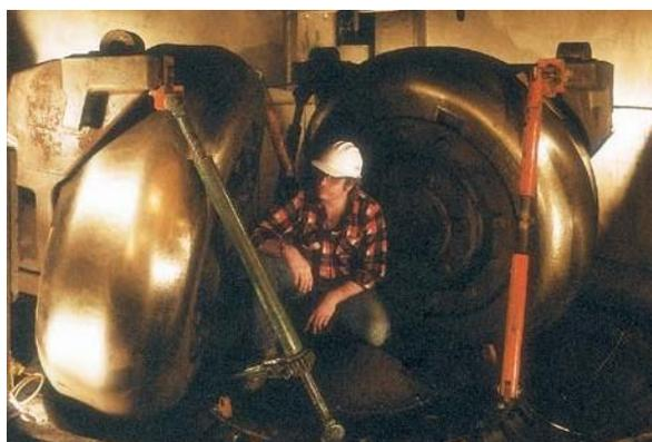
*Una sola puerta de acceso grande, un tamaño pequeño y herramientas especialmente diseñadas son características del pulverizador B&W Roll Wheel que ayudan a reducir los costos de mantenimiento.*
