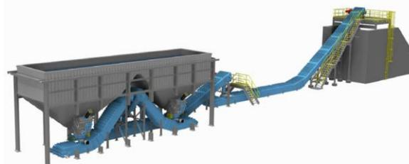
Sistema diseñado para transportar cenizas de fondo deshidratadas desde la tolva a través de una serie de SGC compactos para su descarga en el búnker de almacenamiento
