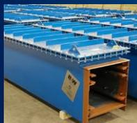
La carcasa de placa gruesa y las superficies de transporte para la inmersión total de la cadena en el agua significan que no hay acumulación descuidada de cenizas húmedas.
